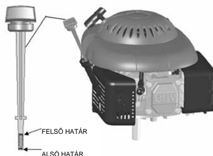
AZ OLAJBEÖNTŐ FEDELE – OLAJMÉRŐ LÉC
