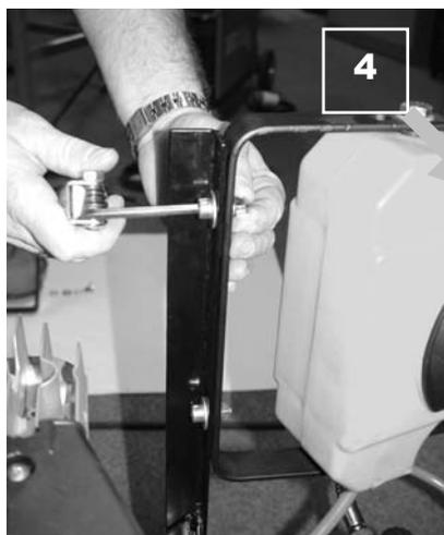
4. Befestigen Sie nun den Schwenkbügel mit der Schlauchtrommel, wie abgebildet, an den Halter
