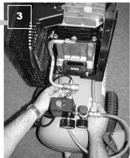
3. Schließen Sie den Luftschlauch an der Druckluftkupplung an und verstauen Sie den Schlauch unter der Kesselkonsole
