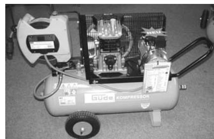
**Information:** bei einigen unserer Kompressorenmodelle sind die Löcher für die Montage des Halters bereits vorgesehen. Bei der Montage auf ein anderes Modell, müssen die Löcher unter Berücksichtigung des Schwenkbereichs der Trommel an einer entsprechenden Ecke der Kesselkonsole gesetzt werden.
