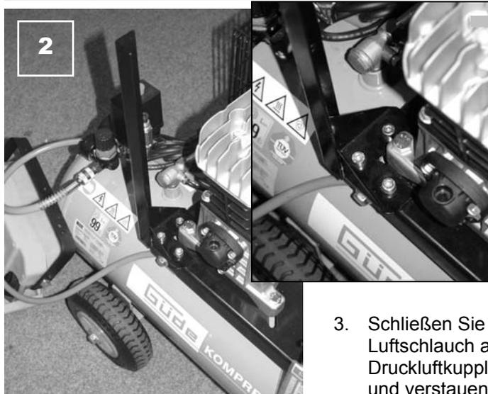
2. Befestigen Sie den Kompressorenhalter mit den 3 Sechskantschrauben an der Kompressorkonsole (s. Abb.)
